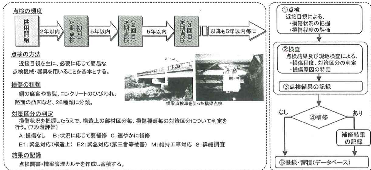
図-2 道路橋定期点検の概要 (直轄橋梁)
