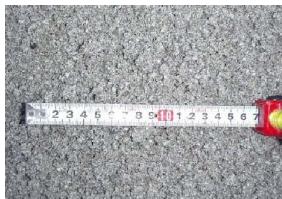
写真-8 研削材 (スポンジブラスト)
