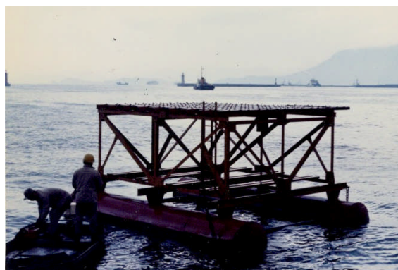
写真1 高松港での海上暴露試験
