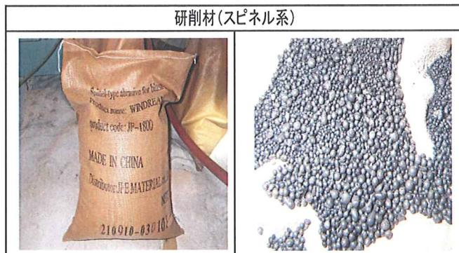
図-8 試験で使用した研削材
