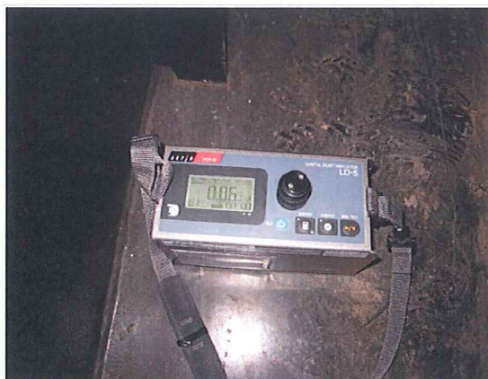
写真-3.12 集塵濃度測定
