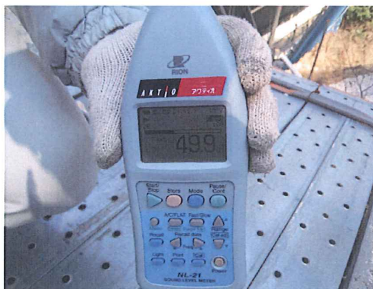
写真-3.13 騒音レベル測定
