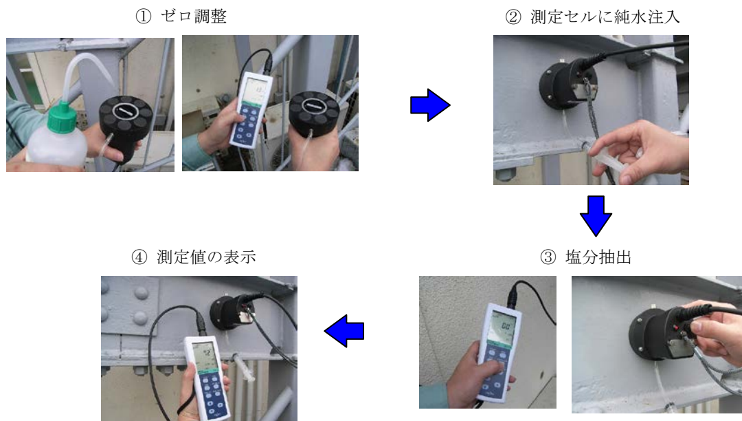
写真-3.1 センサ固定による直接電気伝導率測定法
