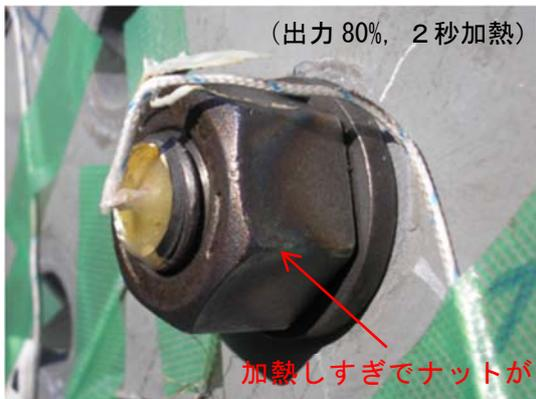
写真-10 過剰な IH 加熱でナットが変色
