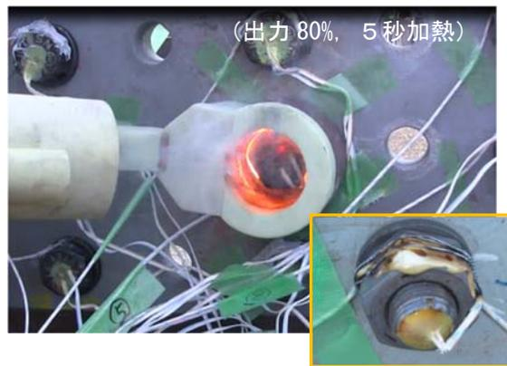
写真-9 IH加熱による煙発生やリード線の焼け
