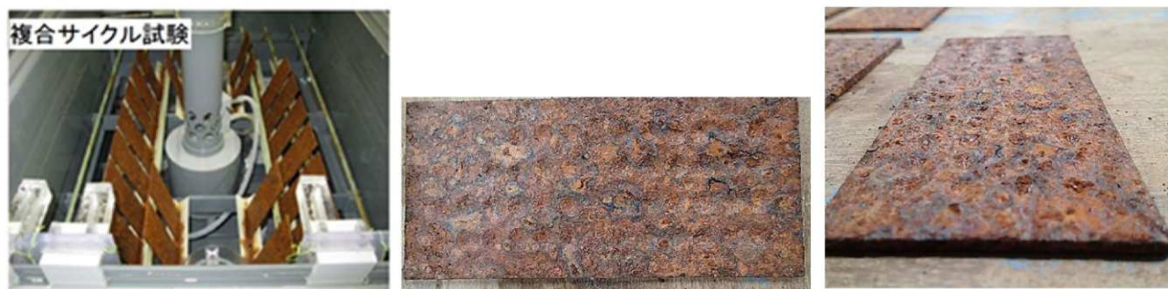
写真-3 腐食促進状況と腐食試験片
