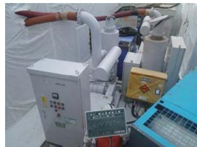
写真-7 真空回収装置 ルーツプロアー
