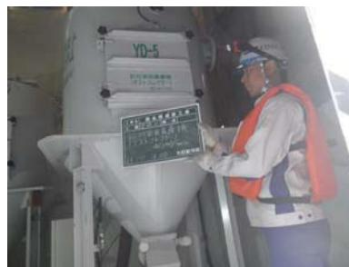
写真-6 ダスト回収機
