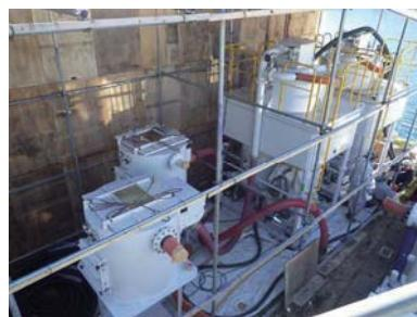
写真-4 セパレーター、ホッパータンク
