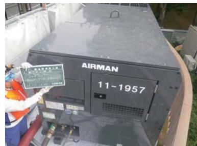
写真-9 エンジンエアーコンプレッサー
