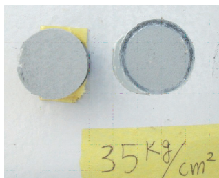
写真-10 下塗層内からのはく離の例
