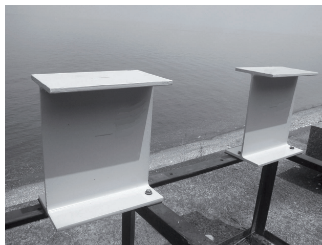
写真-8 H型鋼試験体の設置状況
