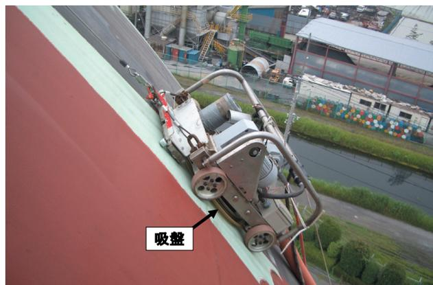
写真-2 剥離ロボット
