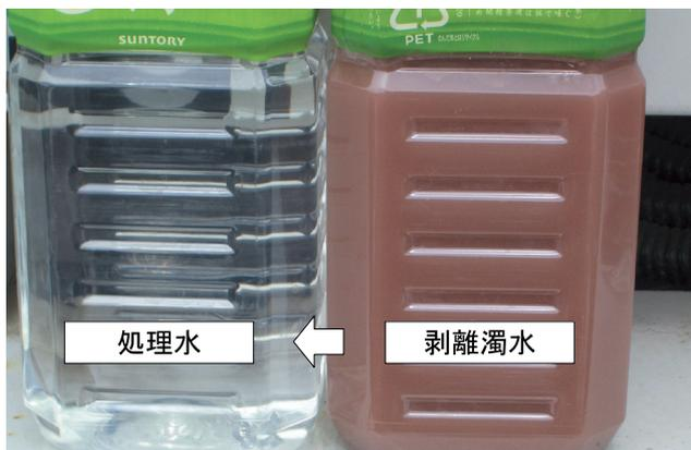
写真-4 剥離濁水と処理水
