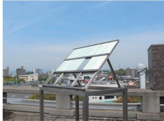
写真-1 テストピース暴露状況
