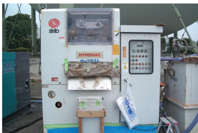
写真-3 廃水処理装置
