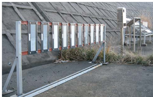
図-8 塗装試験片（塗り重ね部）の曝露
