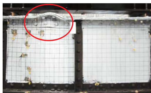
図-7 腐蝕した桁の曲げ試験（上フランジの座屈）
