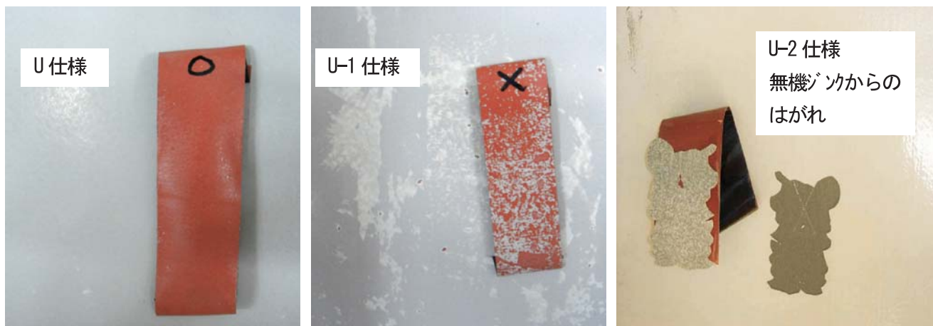
写真-5 布ガムテープによる付着性確認状況
