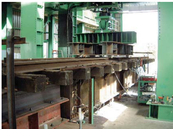
図-8 疲労試験状況
