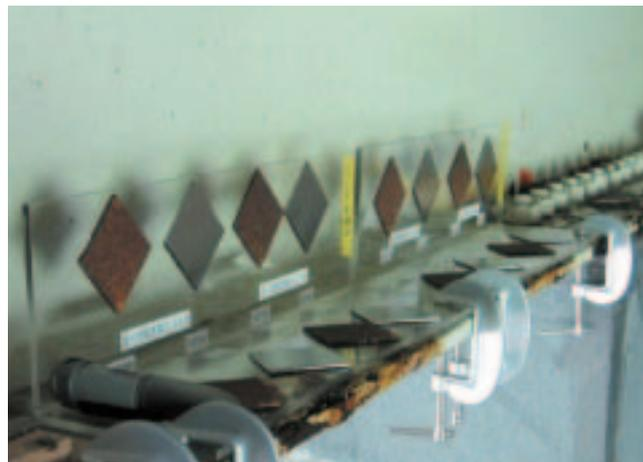
写真-6 洗浄効果確認用の試験鋼板
