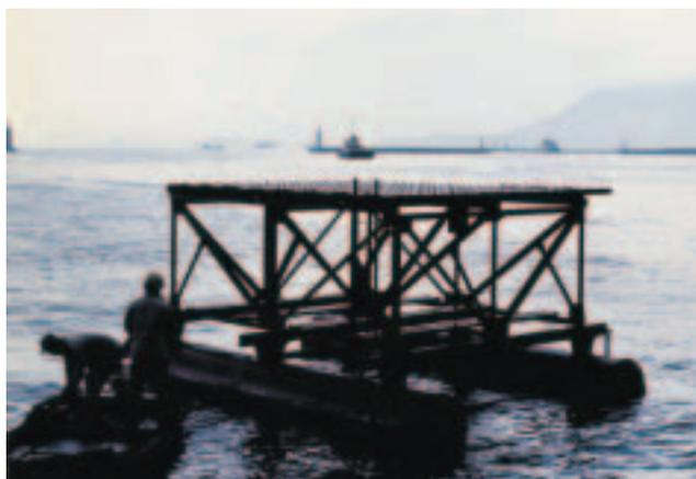
写真-1 高松港での海上いかだ暴露試験
