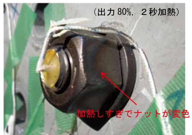
写真-10 過剰なIH加熱でナットが変色
