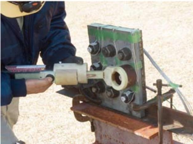
写真-8 ボルト加熱試験状況
