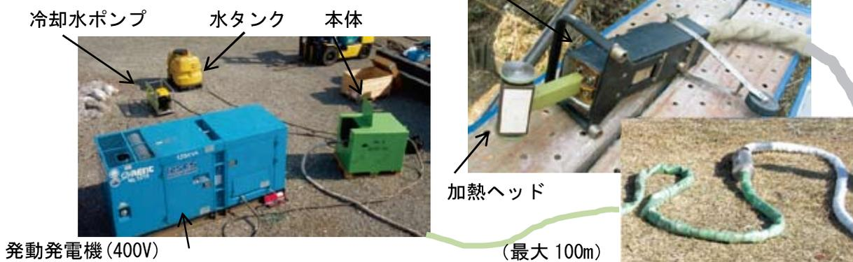
写真-1 電磁誘導加熱式塗膜除去装置の構成
