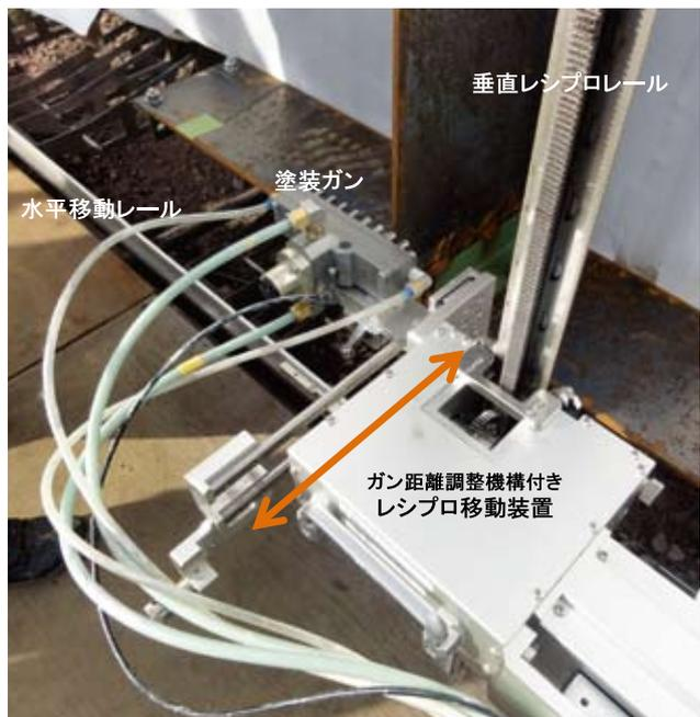
図-16 ガン距離調整機構の外観図
