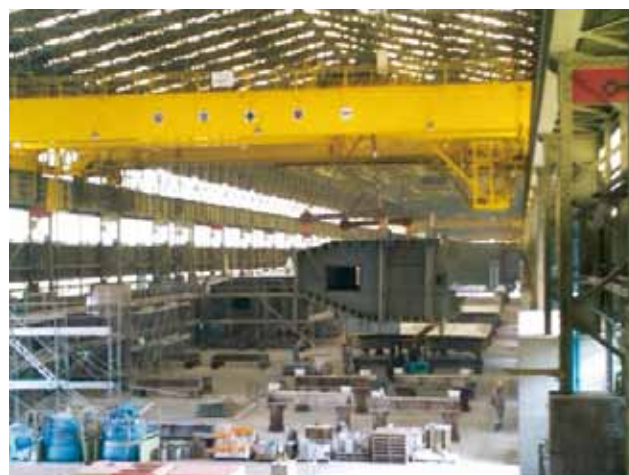
工程⑦：内運状況（ブラスト場⇒溶射場）
