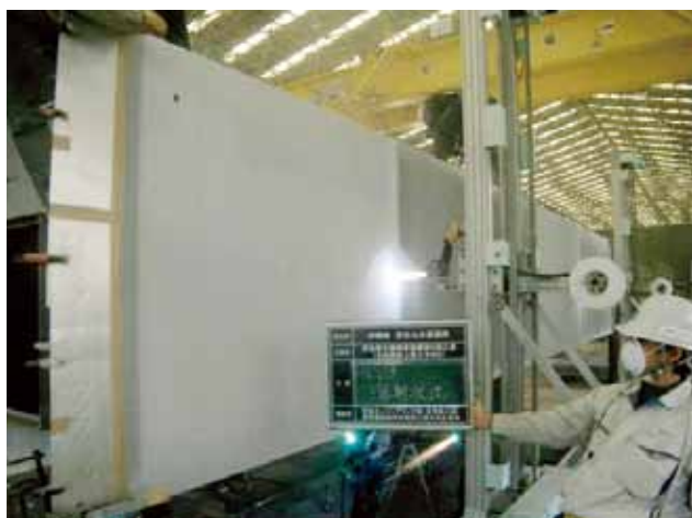
工程⑨：側面溶射狀況（自動機使用）
