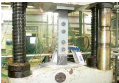
写真-6 すべり耐力試験状況 8)
