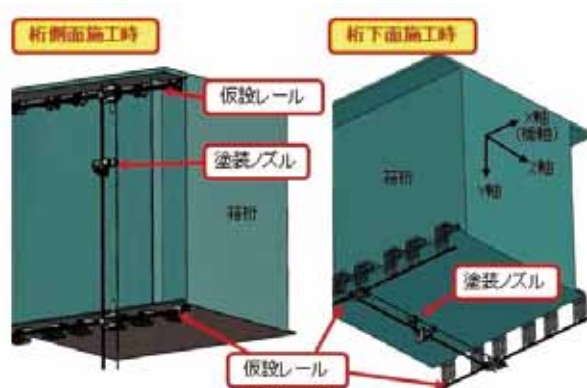
図-1 箱桁用自動塗装機械のイメージ 2)
