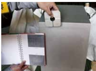
写真-10 除錆度確認
