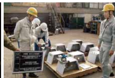
写真-14 アドヒージョン試験状況
