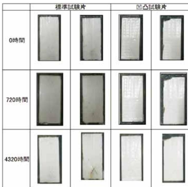
写真-3 試験片外観状況 (抜粋)
