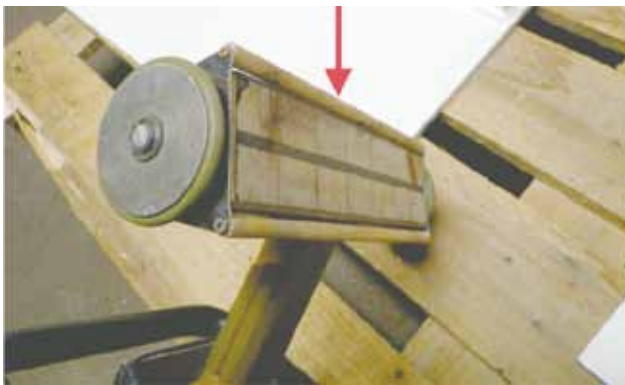
写真-2 加熱コイルの間隔保持治具の改良
