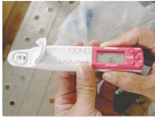
② 回収水の塩分量測定 (電導度法測定器)
