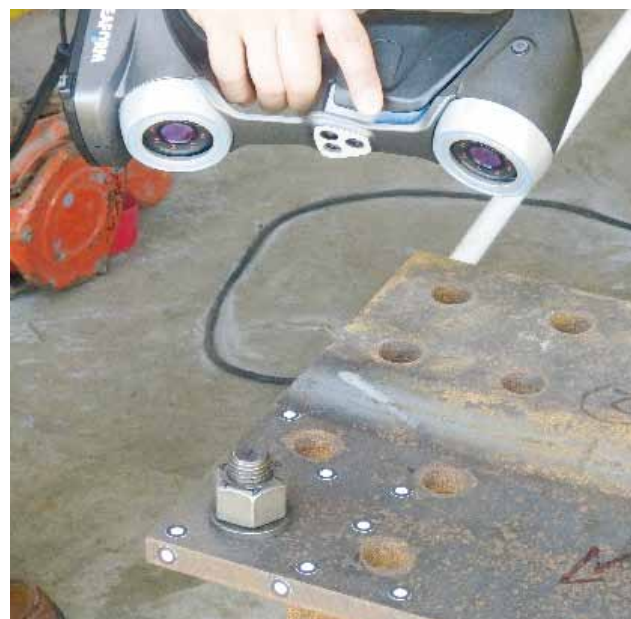
写真-6 3D スキャナによる防食皮膜厚さの測定状況
