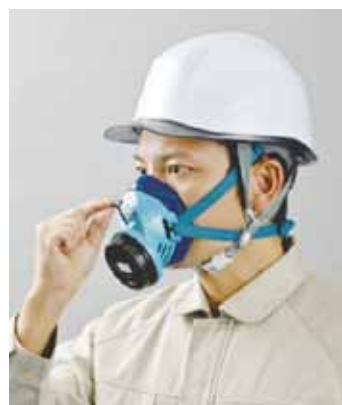
写真-4 フィットテスト(定性的な方法)
