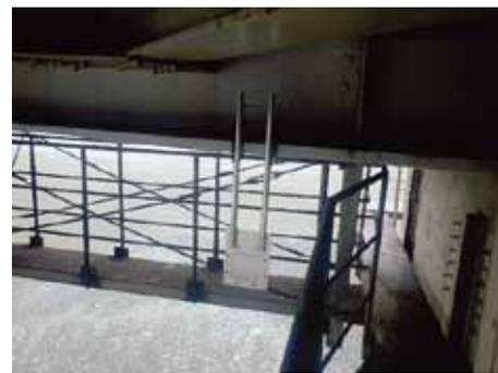
写真-2 ドライガーゼプレート捕集枠設置状況
