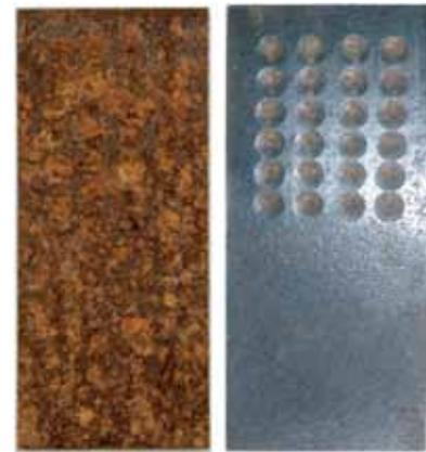
(左：サイクル腐食試験後、右：素地調整2種後)
