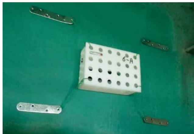
写真-3 温湿度計設置状況
