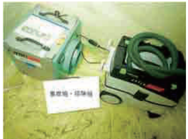
写真-6 集塵機、掃除機の適用
