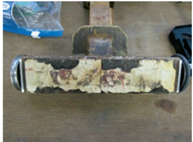
図-17 加熱ヘッドの摩耗状況写真
