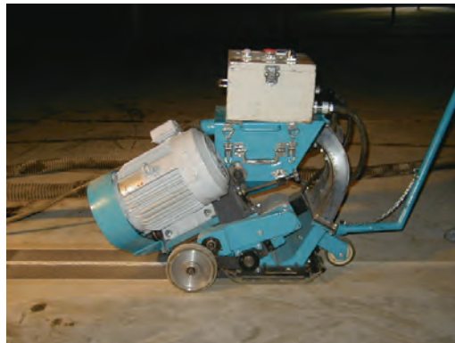
写真-5 小型半自動走行グリッドブラスト機 13)
