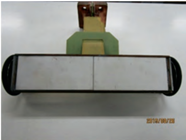
図-17 加熱ヘッドの摩耗状況写真
