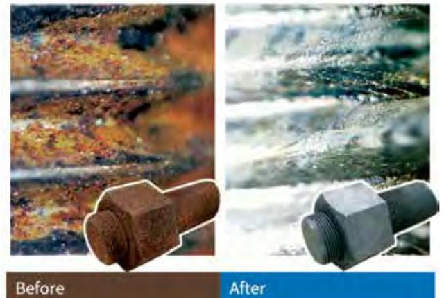
図-5 ネジ部へのレーザー照射処理例
