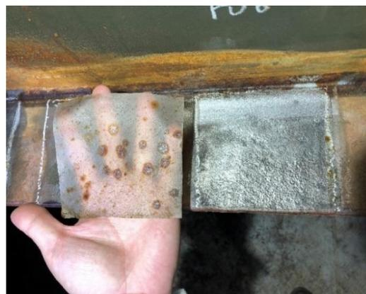
写真7 剥離後の塗膜および処理後の鋼材面
