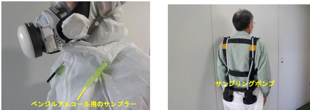
図 3 個人ばく露測定の測定器の装着イメージ
