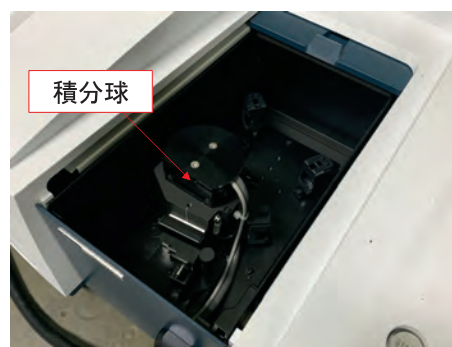
(b)測定部の外観
