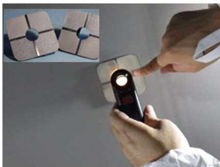
図 3 表面形状比較板 (コンパレータ) 5)
