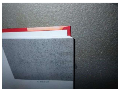
図 12 AWT 処理後の鋼素地の状況 (Sa2 1/2)
