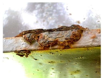
図 3 鋼素地の残留塩による塗膜下からの局部腐食の発生
