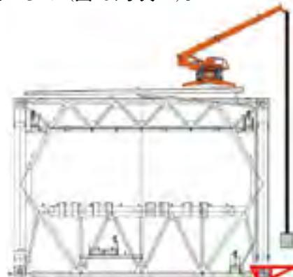
図-6 ステージを使用した搬入・搬出作業
