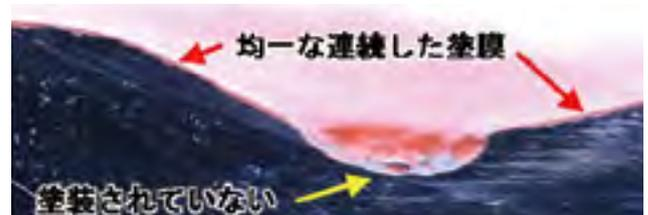
写真-2 ローラで先行塗りした際の断面写真
