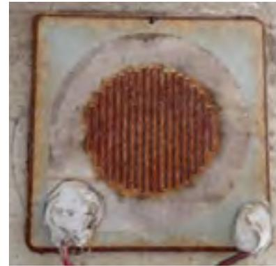
写真-5 回収した ACM センサの外観
