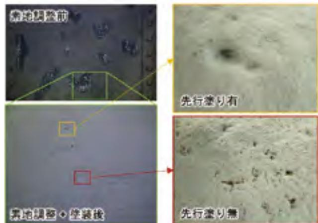
写真-1 刷毛による先行塗りの効果の一例
