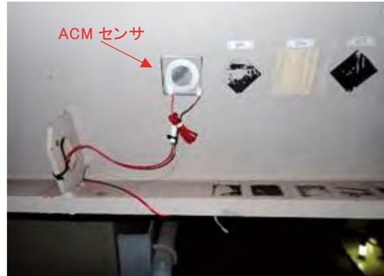
写真-4 ACM センサ設置状況
