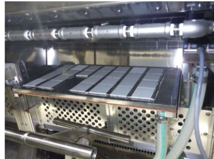
(b) 試験機内部 (試験片設置状況)
