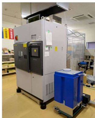
図 4 過酸化水素水供給装置を備えたキセノンアークランプ式試験機の例
