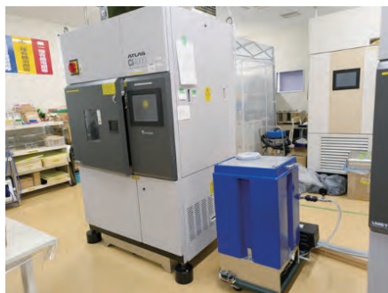
写真-4 キセノンランプ試験機+過酸化水素水 (青い箱に過酸化水素水が入っている)
