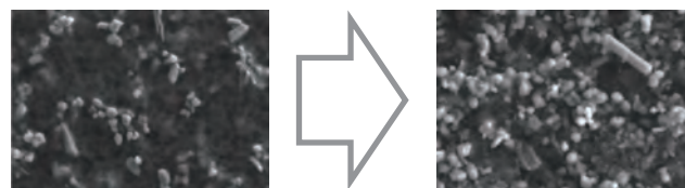
写真-19 G社（水性無機）500 時間後（試験体 2）
