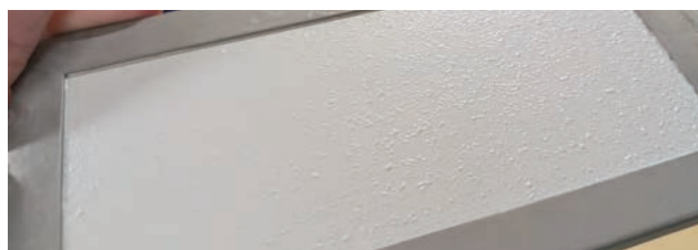
写真-13 C社（水性無機）500 時間後の小粒の膨れ
