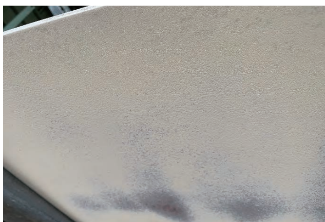
写真-7 試験板（ブラスト+エアブロー後）
