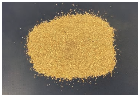
写真-8 使用した研削材（コーン）
